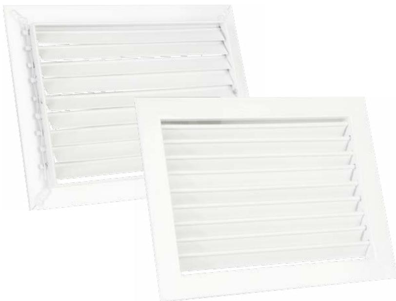
**Описание.** Однорядная нерегулируемая вентиляционная решетка RGN используется в системах приточно-вытяжной вентиляции и кондиционирования. Предназначена для установки в любой проем, возможно использовать в качестве решетки радиатора отопления. Каплевидные жалюзи зафиксированы под углом 35°.
