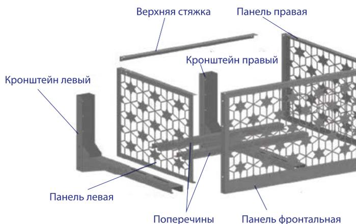
2. Регулировка поперечных направляющих под размер внешнего блока кондиционера.
